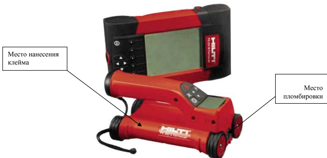
Рисунок 1 - Вид измерителей глубины залегания арматуры PS 200 Ferroscaп место нанесения наклейки место пломбировки
